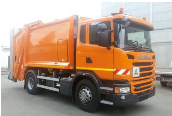
Technické detaily nového vozu: SCANIA G320, DB4x2, 18 t, EURO 6 / RosRoca OLYMPUS 14W (14 m 3 ). Foto: Ekoltes
